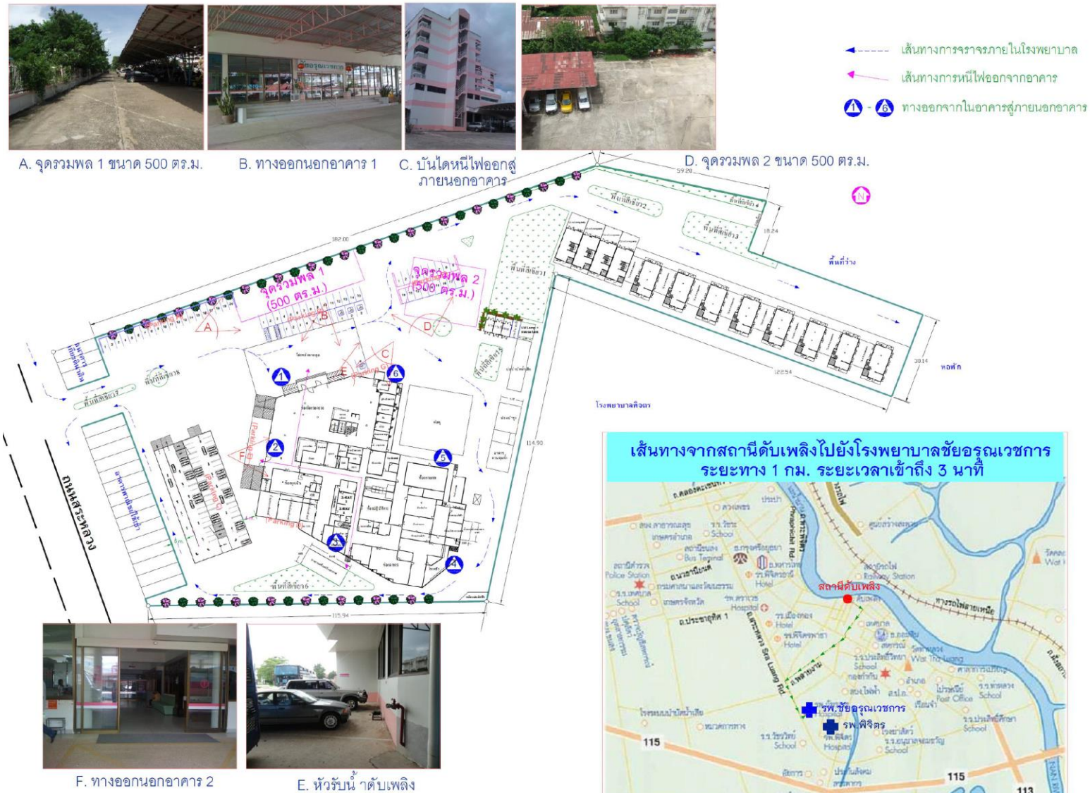
ภาพที่ 1.3.13-1 เส้นทางหนีไฟนอกอาคาร, จุดรวมพล และเส้นทางเข้าถึงของรถดับเพลิง
